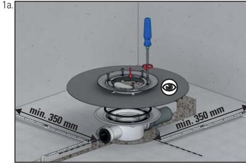
DE Einbau mit Edelstahl-Flanschring
